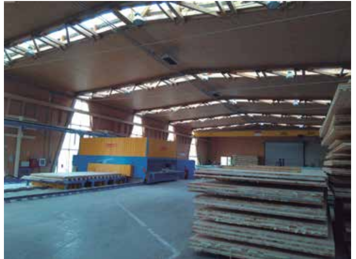
Fotografia 1. En primer pla panells de FLX fabricats a Catalunya amb fusta local. En segon pla un centre de mecanitzat PBA de Hundegger.
