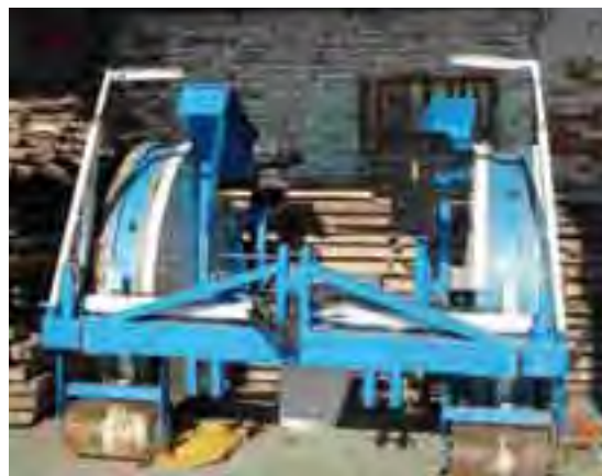
Foto 3. Maquinària de plantar estaques de pollancre per a la plantacions SRF desenvolupada a Itàlia (Allasia vivai, Itàlia).
