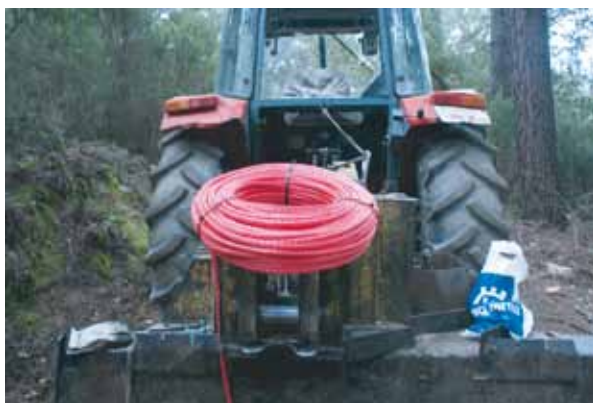
Tractor i cabrestany on es va muntar el cable sintètic
