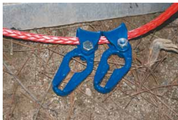
Grillets o "Chokkers" adaptats al cable sintètic
