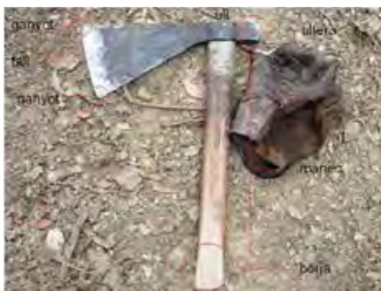
Fotografia 3. Parts de la destreal de pelar.
