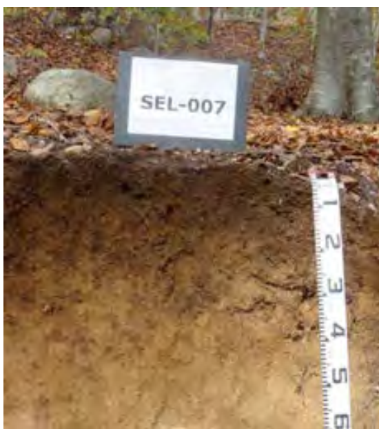
Fotografia 3. Seqüència d'horitzons O-A-Bw-C. Epipèdon òcric de La Selva. Ordre Entisòl (SSS, 2006). Fageda. Extret del Mapa de sòls 1:250.000 de la comarca de La Selva. Font: Institut Geològic de Catalunya, 2011
