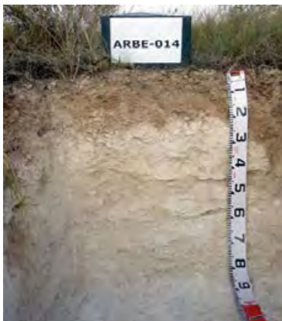
Fotografia 5. Seqüència d'horitzons O-Ap-Bk-2R. Epipèdon òcric i endopèdon càlcic d'Arbeca, Les Garrigues. Ordre Inceptisòls (SSS, 2006). Matollar escleròfil desenvolupat en un conreu abandonat. Extret del Mapa de sòls 1:25.000 de les Borges Blanques. Font: Institut Geològic de Catalunya, 2011
