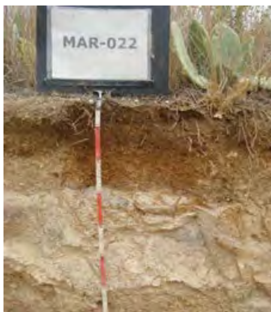
Fotografia 10. Seqüència d'horitzons O-A-R. Epipèdon òcric del Maresme. Ordre Entisol (SSS, 2006). Bosc escleròfil. Extret del Mapa de sòls 1:250.000 de la comarca del Maresme. Font: Institut Geològic de Catalunya, 2011
