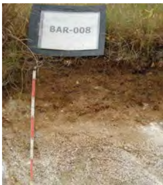
Fotografia 9. Seqüència d'horitzons O-A-C-R. Epipèdon òcric del Barcelonès. Ordre Entisol (SSS, 2006). Bosc escleròfil. Extret del Mapa de sòls 1:250.000 de la comarca del Barcelonès. Font: Institut Geològic de Catalunya, 2011
